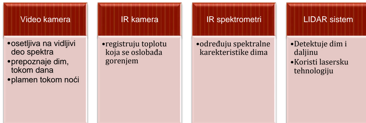
Slika 2. Različiti tipovi senzora za detekciju požara sa zemlje
