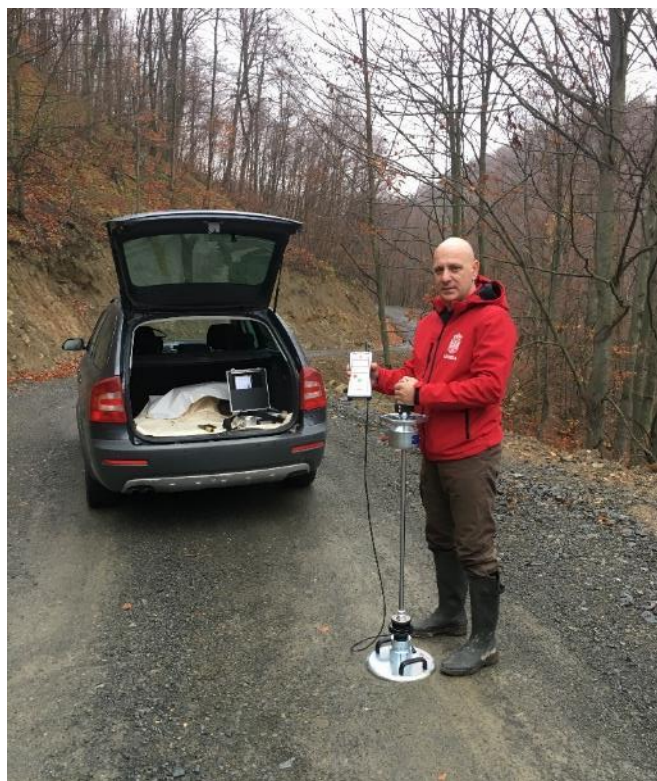
Слика 17: Испитивање динамичког модула деформације на шумском путу "Пилана - Врба"
