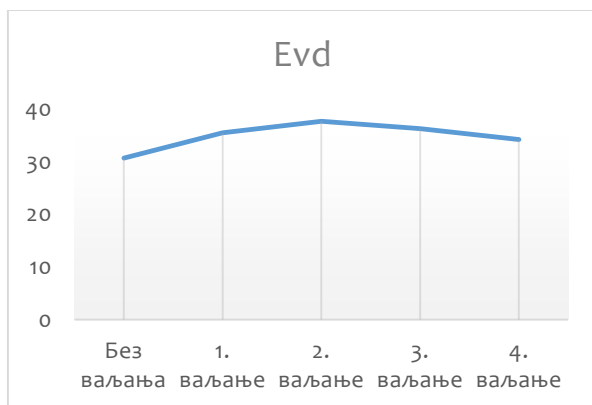
Графикон 1: Промена вредности E_{vd} са бројем преласка ваљка
