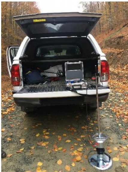
Слика 20: Мерење збијености на шумском путу „Ваља река“
