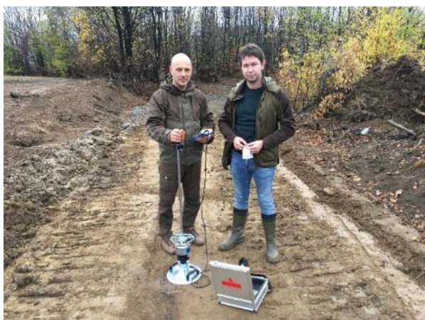
Слика 15: Испитивање динамичког модула збијености пре ваљања
