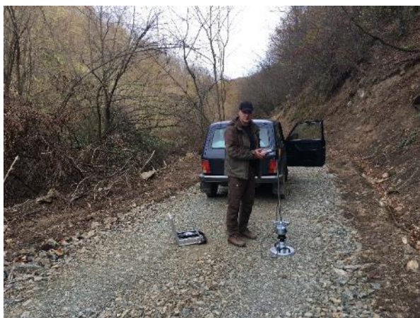
Слика 18: Испитивање на шумском путу „Беочић-Бела Грача-Змајевица“ уређајем ZFG 3.0 GPS
