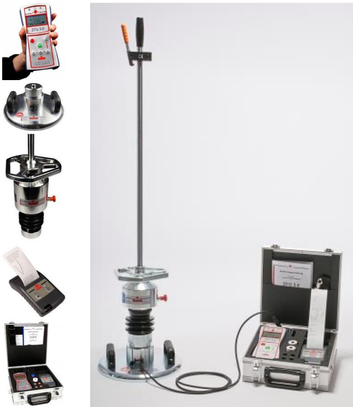
Слика 1: Делови уређаја ZORN ZFG 3.0 GPS
