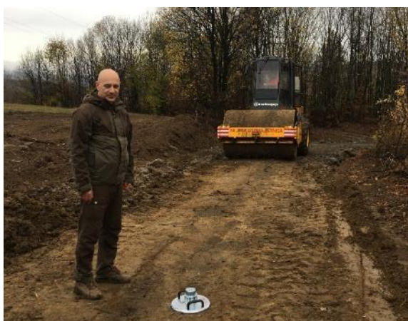
Слика 16: Испитивање динамичког модула збијености након првог преласка ваљка
