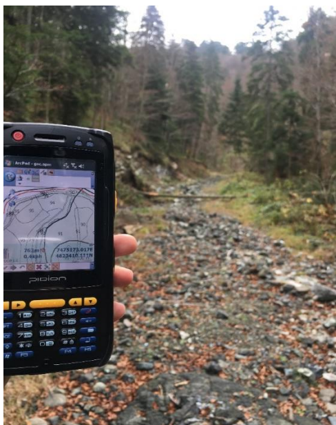
Слика 1: Снимање путева и влаке ГПС уређајем
