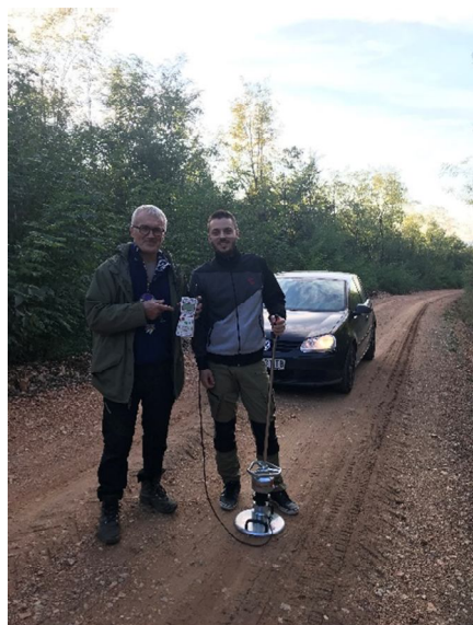
Слика 59: Мерење збијености на шумском путу „Везичево - Дрењар“
