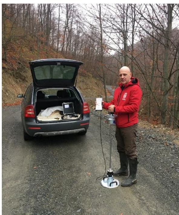
Слика 32: Испитивање динамичког модула деформације на шумском путу "Пилана - Врба" 2019. год.
