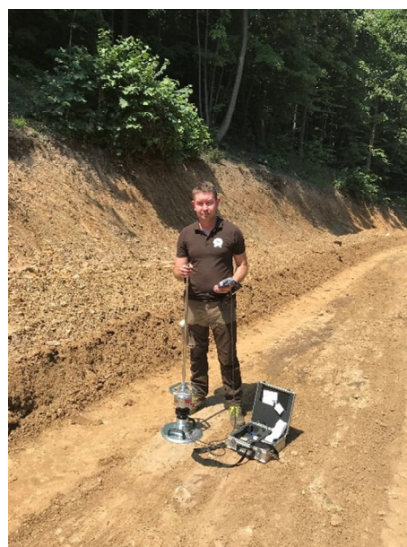
Слика 87: Испитивање E_{vd} на постељици шумског пута "Пољана - Ловачко имање"
