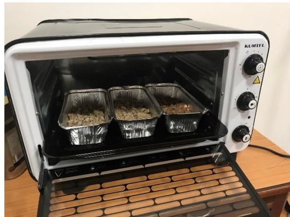
Слика 3: Сушење узорка
