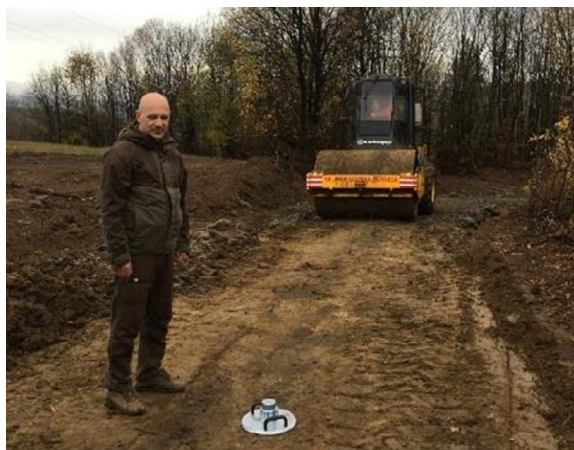
Слика 29: Испитивање динамичког модула збијености након првог преласка ваљка
