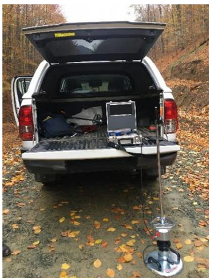
Слика 40: Мерење збијености на шумском путу „Ваља реа“
