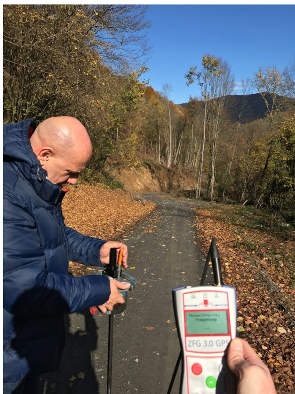
Слика б4: Испитивање E_{vd} на шумском путу "Новаковићи - Костојевићи" 2021. год.
