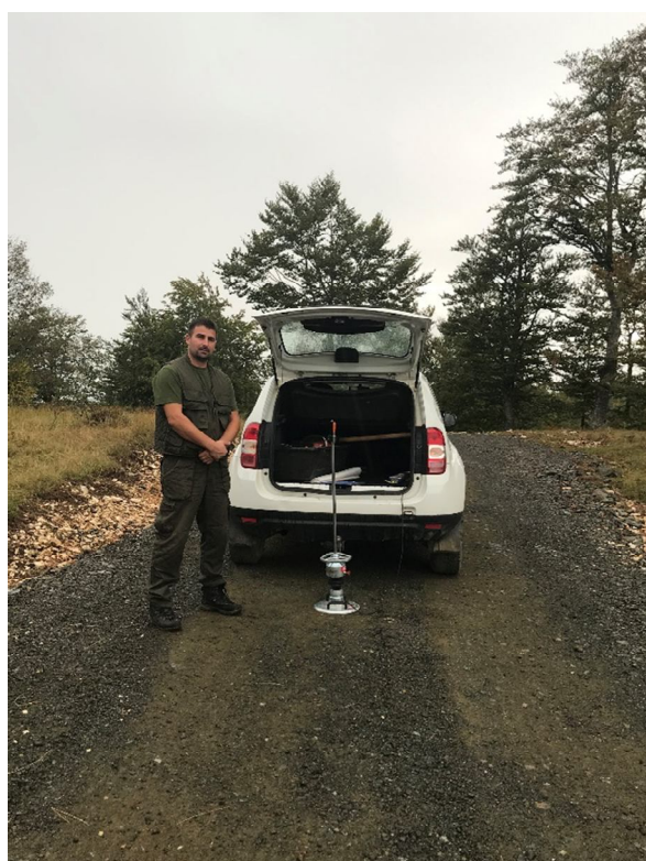
Слика 52: Мерење E_{vd} на шумском путу "Чутурска ливада - Милошевац" 2020. год.
