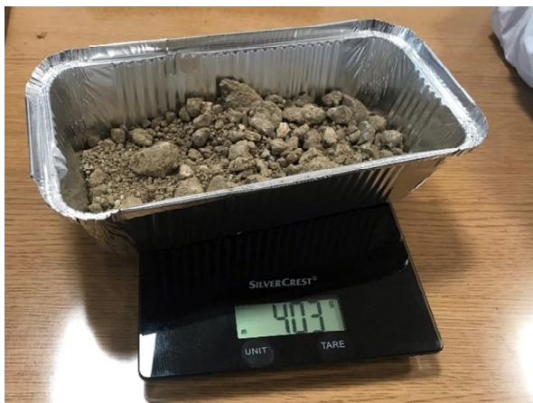
Слика 2: Мерење бруто масе узорка
