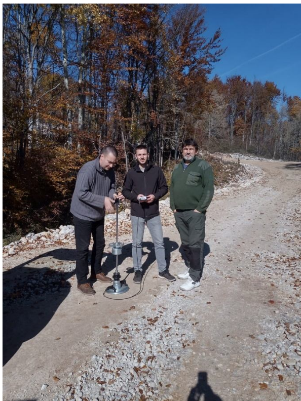
Слика 80: Испитивање Evd на шумском путу "Бежиште - Три локве" 2021. год.
