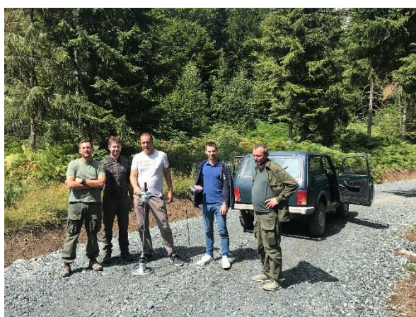
Слика 79: Испитивање Evd на шумском путу "Црвене клеке - Каменито брдо"
