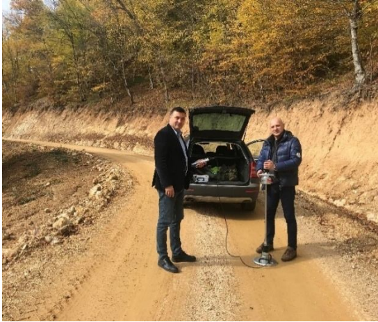
Слика 68: Мерење E_{vd} на шумском путу "Девотин - Стамболка - Китке" 2021. год.
