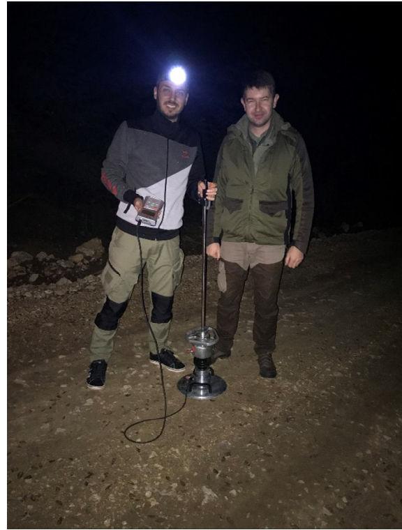
Слика б2: Мерење ДМД на шумском путу "Ђовдин - Дрењар"
