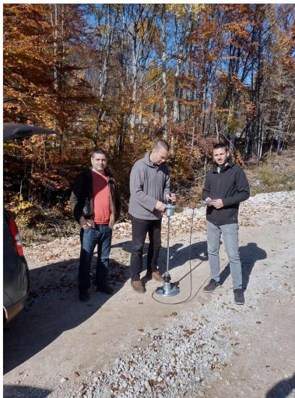
Слика 81: Испитивање Evd на шумском путу "Бежиште - Три локве" 2021. год.
