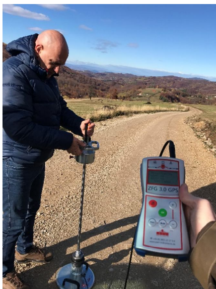
Слика 57: Испитивање E vd на шумском путу "Дебело брдо - Маџарија" 2021. год.
