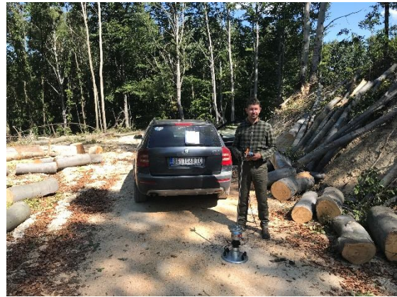
Слика 50: Мерење Evd на шумском путу "Плавчево - Штубеј" 2021. год.
