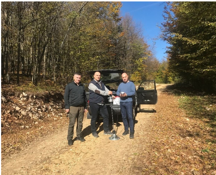
Слика 84: Мерење E_{vd} на шумском путу "Торовиште - Копривно брдо" 2021. год.
