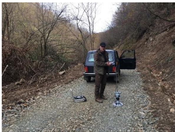
Слика 38: Испитивање на шумском путу „Беочић-Бела Грача-Змајевица“ уређајем ZFG 3.0 GPS
