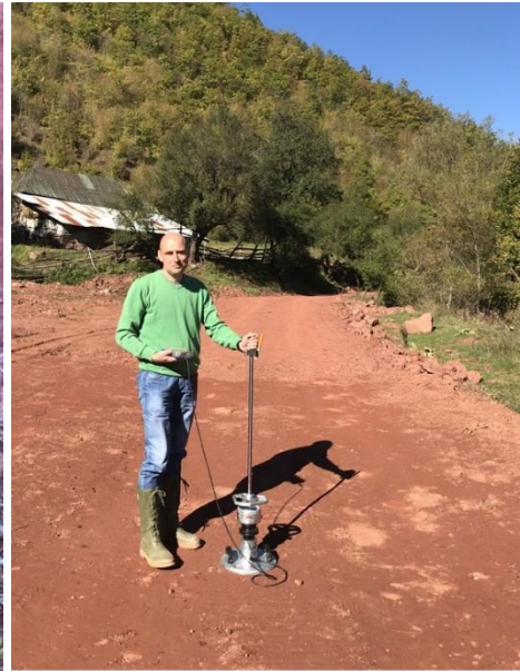
Слика 76: Мерење ДМД на постељици шумског пута „Топли До – Селиште“
