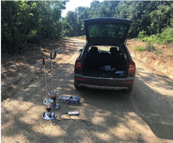
Слика 88: Шумски пут „Пољана – Ловачко имање“ – упоредни тест ZORN ZGF 3.0 GPS и TERRATEST 5000 BT
