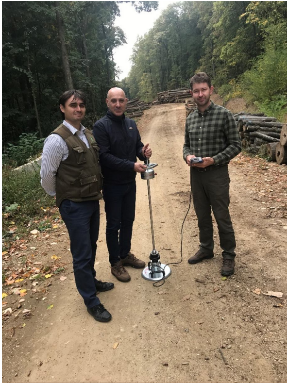
Слика 90: Мерење E_{vd} на шумском путу "Пољана - Ловачко имање" 2021. год.
