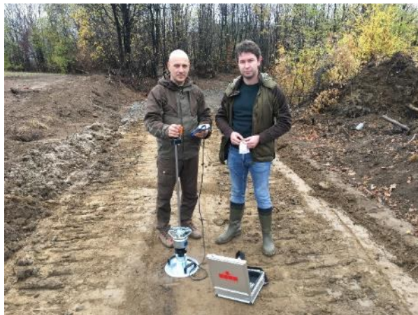
Слика 28: Испитивање динамичког модула збијености пре ваљања
