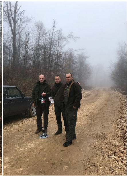
Слика 83: Мерење ДМД на шумском путу „Торовиште – Копривно брдо“
