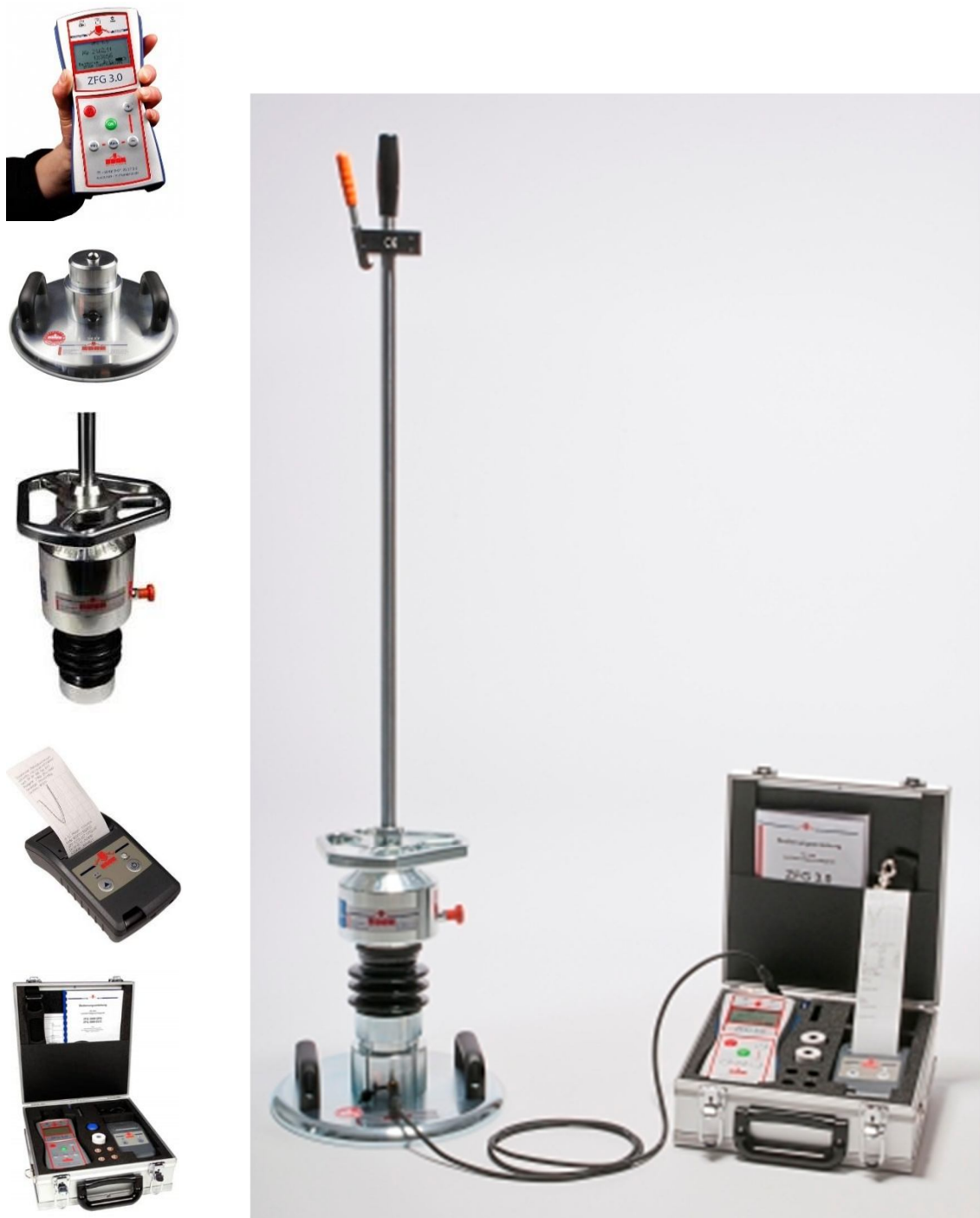
Слика 1: Делови уређаја ZORN ZFG 3.0 GPS
