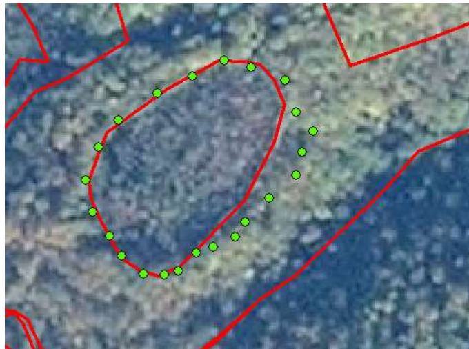
Подаци преузети са GPS уређаја после провере граница на терену (зелена боја)
