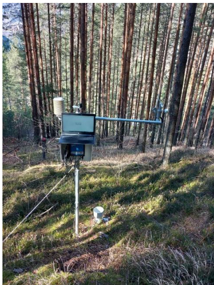
Слика 20.5. и 20.6. Метеоролошка станица за аутоматска мерења микроклиматских услова, Огледно поље Ниво-а II, Мокра Гора
