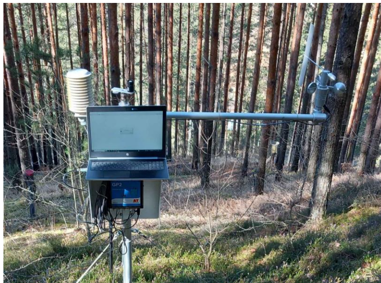
Слика 20.5. и 20.6. Метеоролошка станица за аутоматска мерења микроклиматских услова, Огледно поље Ниво-а II, Мокра Гора
