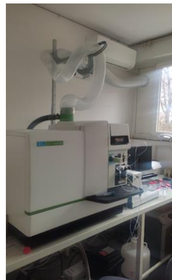
Слика 14.7. Припрема узорка и одређивање концентрације елемената од интереса у узорцима депозиције на ICP- MS спектрометру
