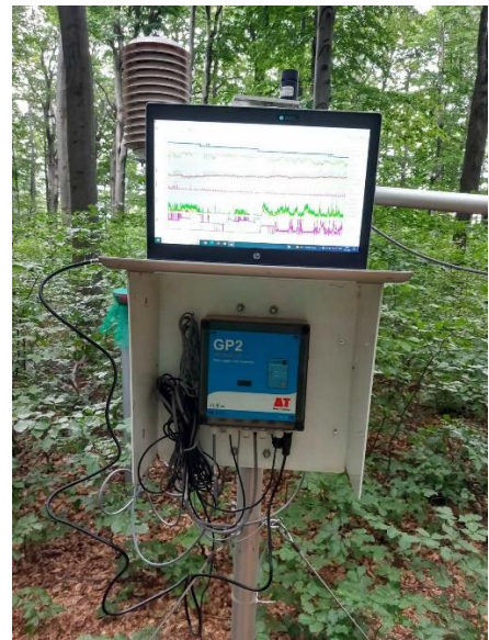
Слике 20.3. и 20.4. Метеоролошка станица за аутоматска мерења микроклиматских услова, Огледно поље Ниво-а II, Црни врх Figure 20.3. and 20.4. Weather station for automatic measurements of microclimatic conditions, Level II sample plot, Crni vrh
