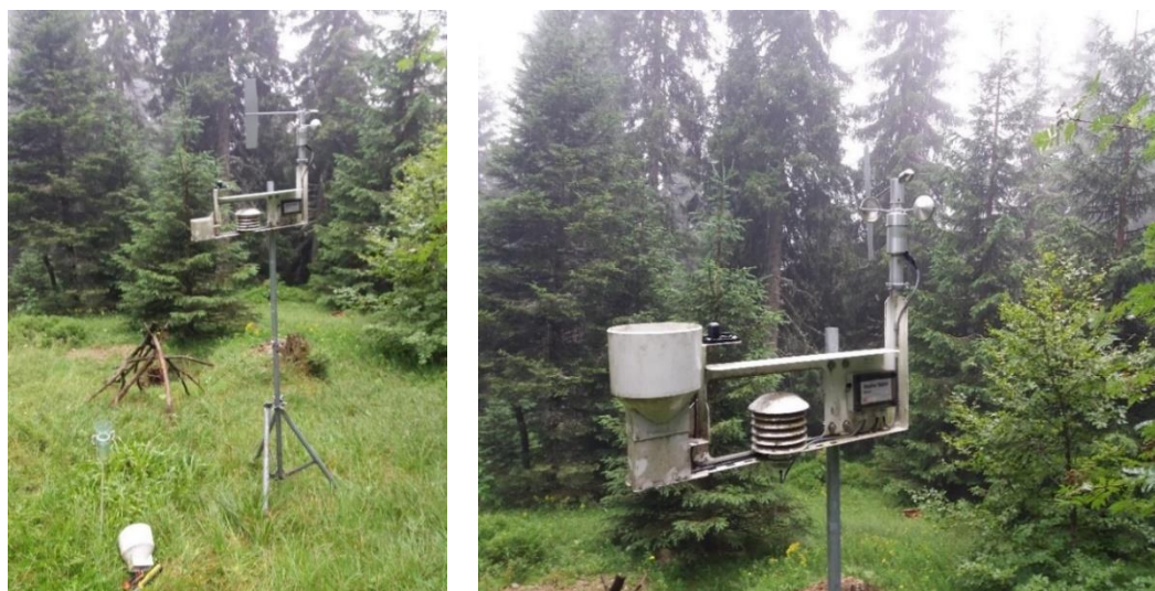
Слике 20.1. и 20.2. Метеоролошка станица за аутоматска мерења микроклиматских услова, Огледно поље Ниво-а II, Копаоник
