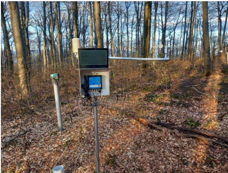
Слике 20.3. и 20.4. Метеоролошка станица за аутоматска мерења микроклиматских услова, Огледно поље Ниво-а II, Црни врх Figure 20.3. and 20.4. Weather station for automatic measurements of microclimatic conditions, Level II sample plot, Crni vrh
