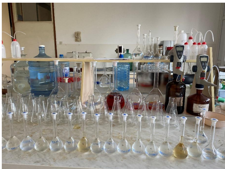
Слика 14.6. Припрема узорака за одређивање алкалитета Figure 14.6. Preparation of samples for alkalinity determination
