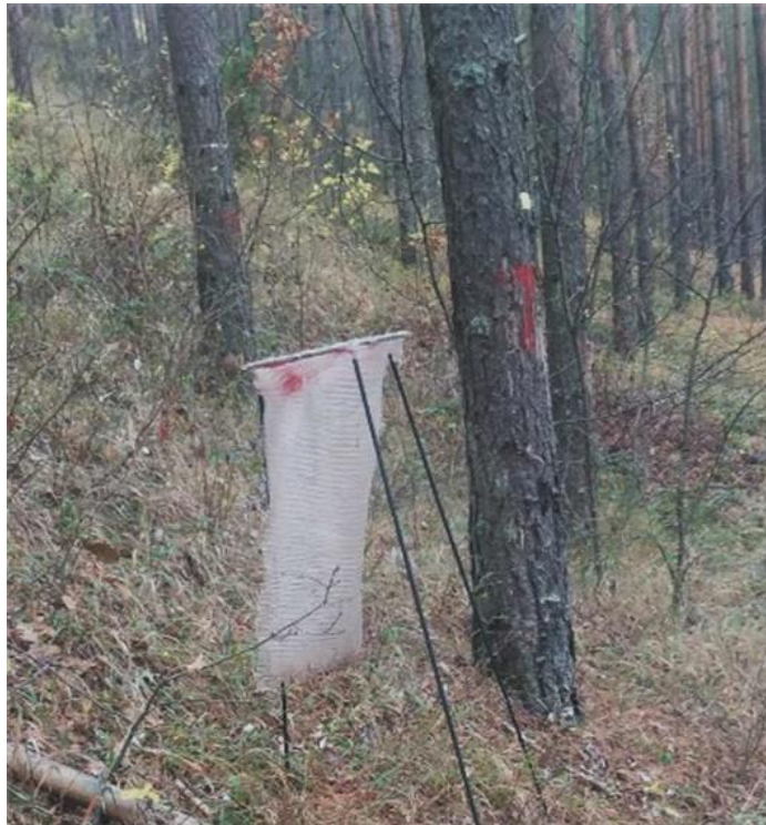
Слика 13.1. Колектор за сакупљање четина – лисног опада БИТ Ниво II – Мокра Гора Figure 13.1. Litterfall sampler that collects needles, Level II SP, Mokra Gora
