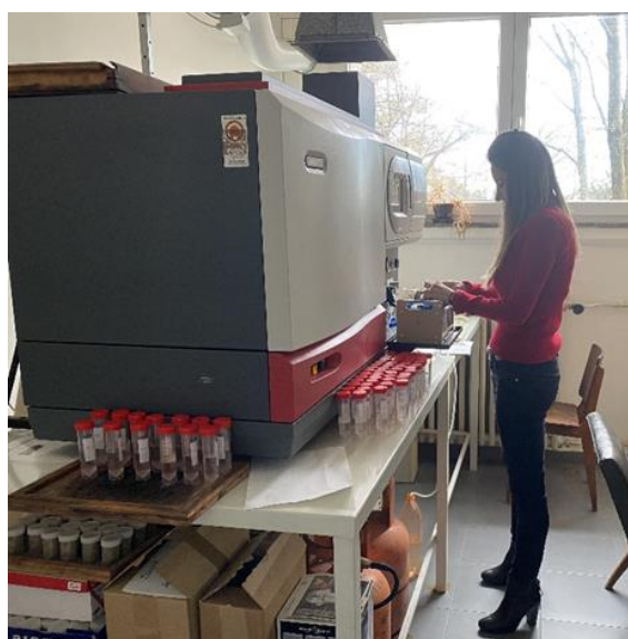
Слика 14.7. Одређивање концентрације елемената од интереса у припремљеним узорцима депозиције на ICP-OES спектрометру Figure 14.7. Determining the concentration of the elements of interest in the prepared deposition samples on the ICP-OES spectrometer
