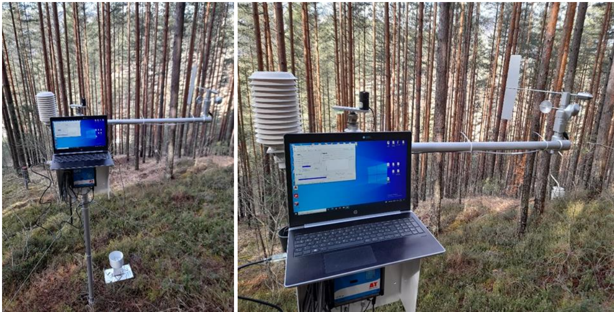
Слика 21.5. и 21.6. Метеоролошка станица за аутоматска мерења микроклиматских услова, Огледно поље Нивоа II, Мокра Гора
