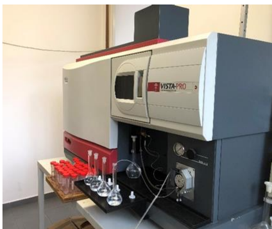
Слика 14.9.-14.10. Одређивање концентрације елемената од интереса у припремљеним узорцима депозиције на ICP-OES спектрометру
