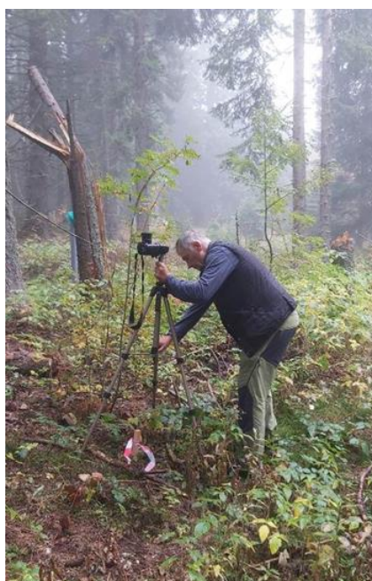
Слика 20.1. Подешавање статива на висину сочива од 1,3 m Figure 20.1. Adjusting the tripod to the lens height of 1.3 m
