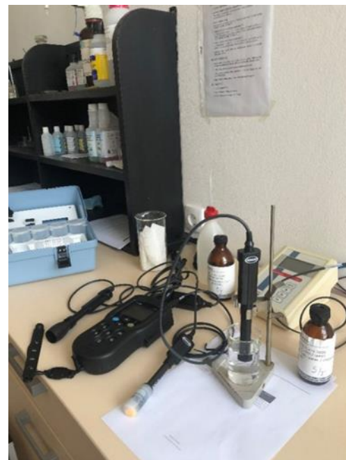
Слика 14.7.-14.8. Одређивање кондуктивитета и рН вредности у узорцима депозиције и референтним узорцима за тест оспособљености Figures 14.7.-14.8. Determination of conductivity and pH values in deposition samples and reference samples for the aptitude test
