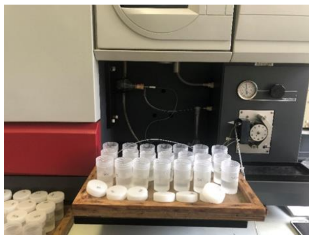
Слика 14.9.-14.10. Одређивање концентрације елемената од интереса у припремљеним узорцима депозиције на ICP-OES спектрометру
