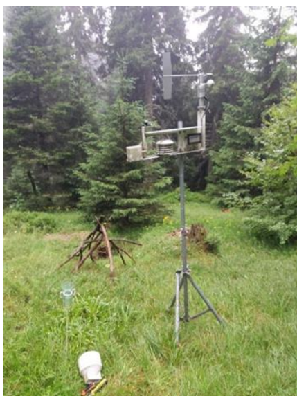
Слике 21.18. и 21.19. Метеоролошка станица за аутоматска мерења микроклиматских услова, огледно поље Ниво-а II, Копаоник
