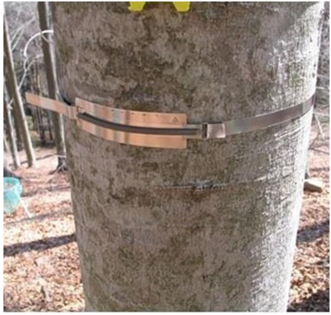
Слика 29.2. Мануелни дендрометар Figure 29.2. Manual dendrometer
