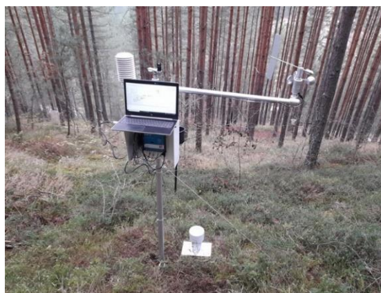
Слике 21.6-21.11. Постављање метеоролошке станице WS-GP2 на огледном пољу Нивоа II, Мокра Гора Figures 21.6-21.11. Installation of weather station WS-GP2, Level II sample plot Mokra Gora
