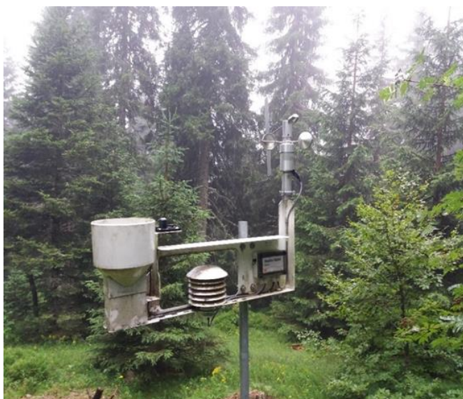
Слике 21.18. и 21.19. Метеоролошка станица за аутоматска мерења микроклиматских услова, огледно поље Ниво-а II, Копаоник
