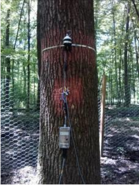
Слика 29.1. Електронски дендрометар Figure 29.1. Electronic dendrometer
