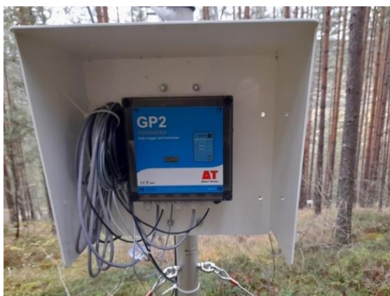
Слике 21.6-21.11. Постављање метеоролошке станице WS-GP2 на огледном пољу Нивоа II, Мокра Гора Figures 21.6-21.11. Installation of weather station WS-GP2, Level II sample plot Mokra Gora
